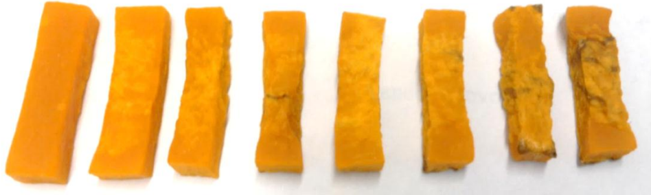
Figura 7. Perfil de secado de la Ahuyama ( Cucurbita maxima ) a una potencia de secado por microondas a 400 W
