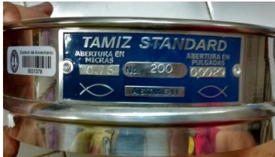
Figura 47. Tamiz Standard #200 (250 \mu m) según norma A.S.T.M. E-11 Fuente: Autores del proyecto.
