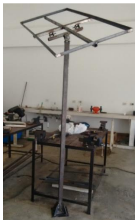
Figura 61. Estructura seguidor solar Fuente: Elaboración propia.
