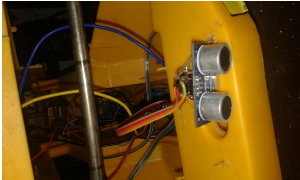
Figura 48. Instalación de sensores ultrasónico
