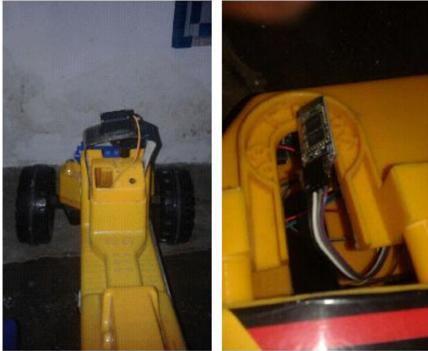
Figura 41. Instalacion servomotor y bluetooth
