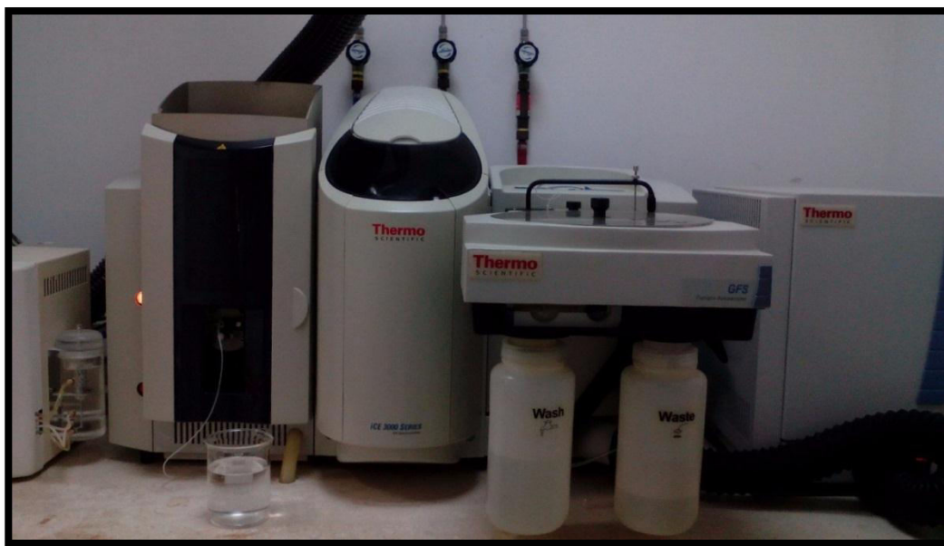
Foto 2. Espectrómetro modelo iCE 3000 Series de marca Thermo Scientific. Tomado de: Autor 2016
