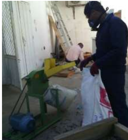
Figura 20 Máquina trituradora. Proceso de trituración de biomasa.
