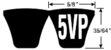
Figura 18. Medidas de la correa del sistema de transmisión de potencia
