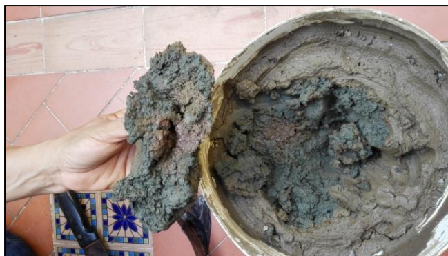
Ilustración 3. Mezcla de suelo y solución de Hg para concentración de 1 \mu\text{g}/\text{g}
