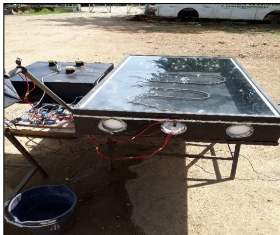
Figura 20 sistema con serpentín y reservorio de agua.
