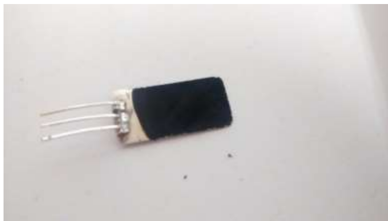
Figura 22 Película polimérica adherida al electrodo de trabajo
