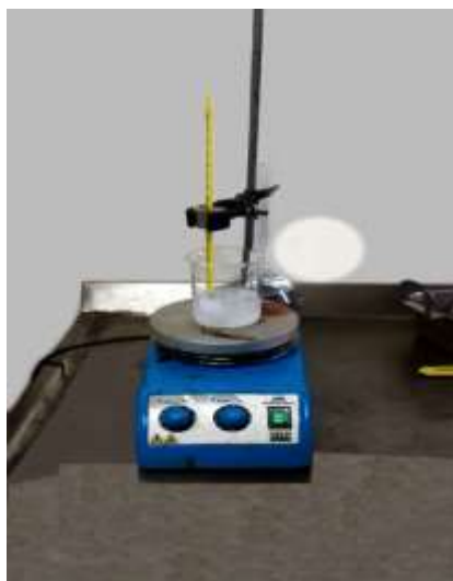
Figura 16 Disolución de PVA en agua destilada en agitador magnético.
