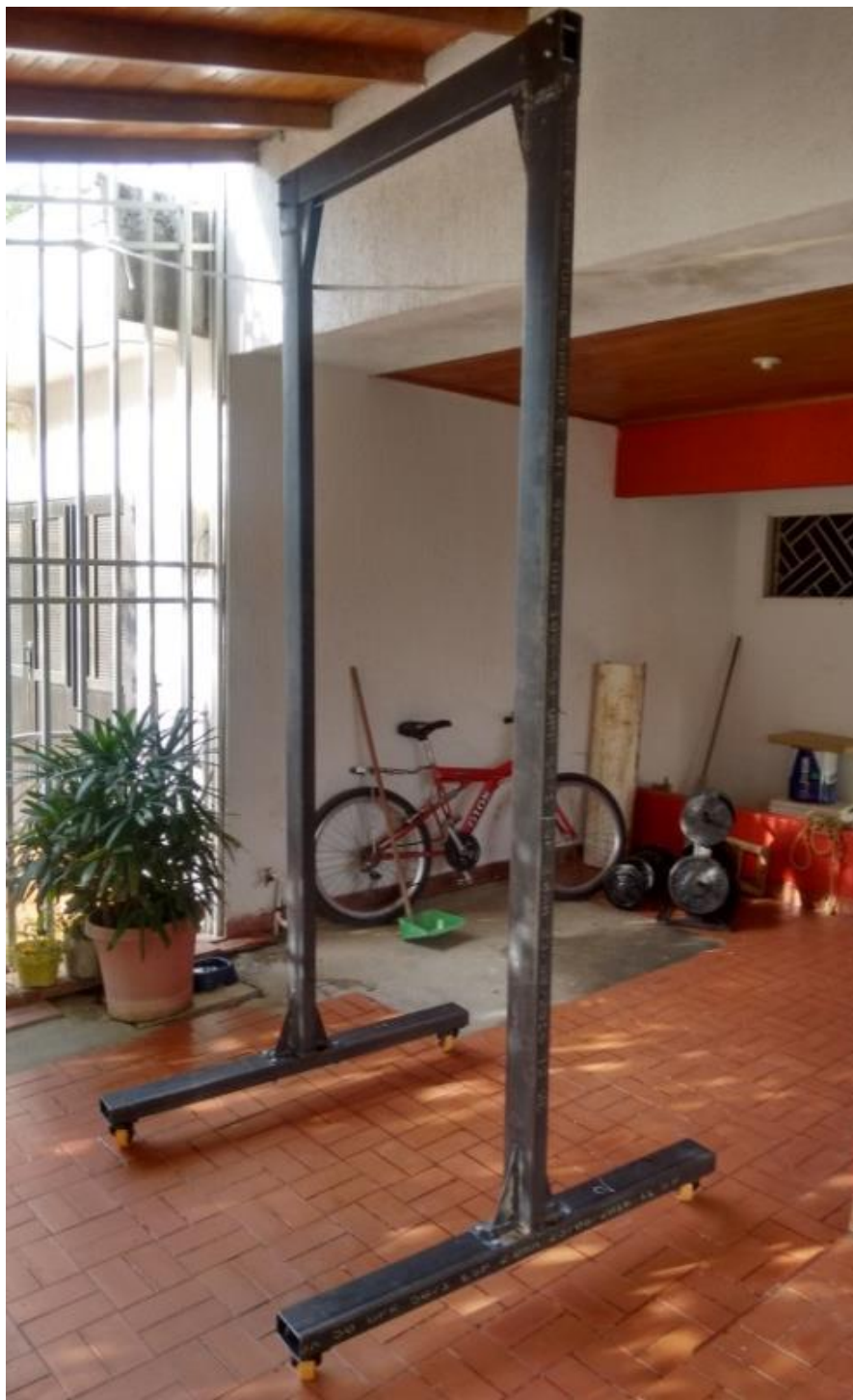
Figura 53. Ensamble de la estructura con las ruedas.
