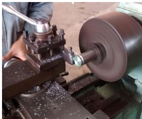
Figura 47. Proceso de ranurado y refrentado en el torno.
