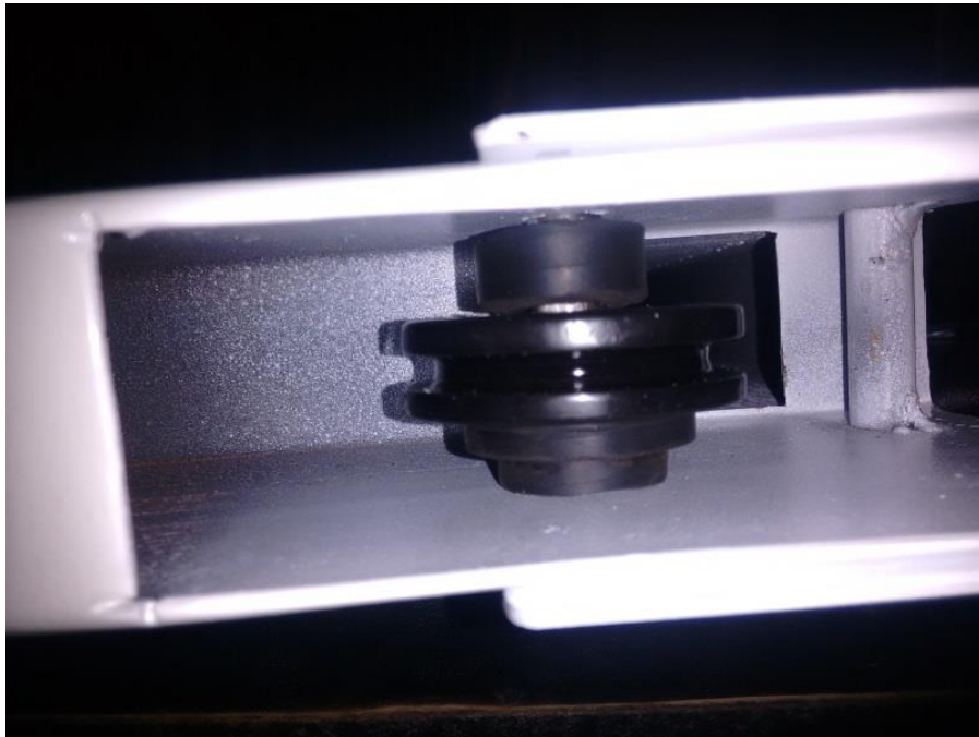
Figura 54. Ensamble de polea dentro de la estructura.
