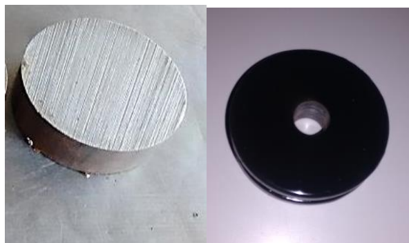
Figura 45. Material sin mecanizar y luego de mecanizar.
