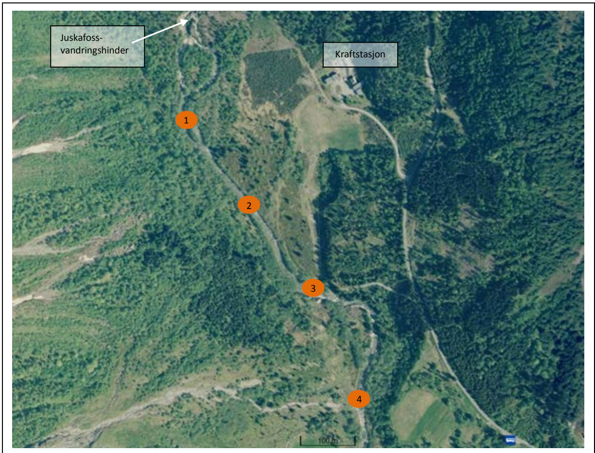
Figur 23. Oversikt over de fire foreslåtte lokalitetene hvor det ble lagt ut gytegrus. Moderate terrengjusteringer ble utført for å sikre gytegrusen bedre mot utspyling ved stor flom på områdene.
