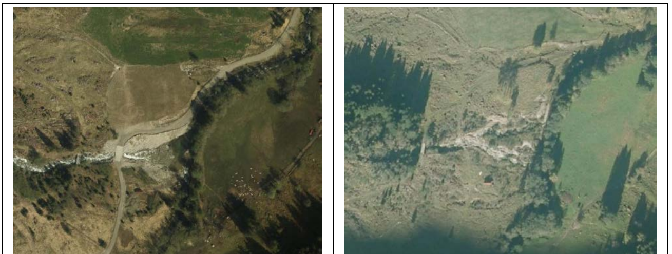
Bildet til venstre er fra 2018 og viser at det er laget en fangdam i Eselvi. Bildet til høyre er tatt i 2010.
