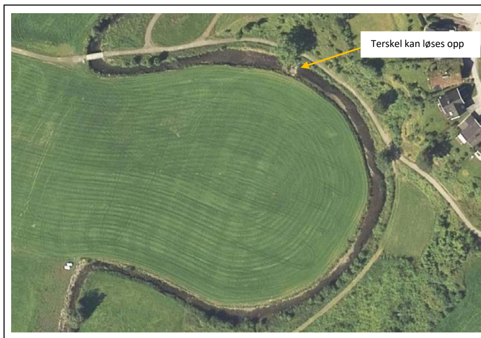
Flere steder er kantvegetasjonen fjernet i Hopra. Denne bør revegeteres. Terskelen kan med fordel løses opp ved å ta ut en eller flere blokker.
