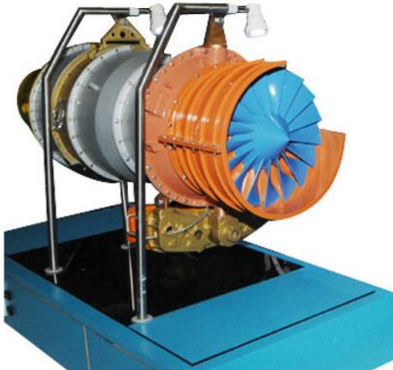
Kuva 15. 25-kN lentokoneen moottorin prototyyppi, joka on valmistettu SLS-menetelmällä. (Wimpenny, Pandey et al. 2017 s. 48)
