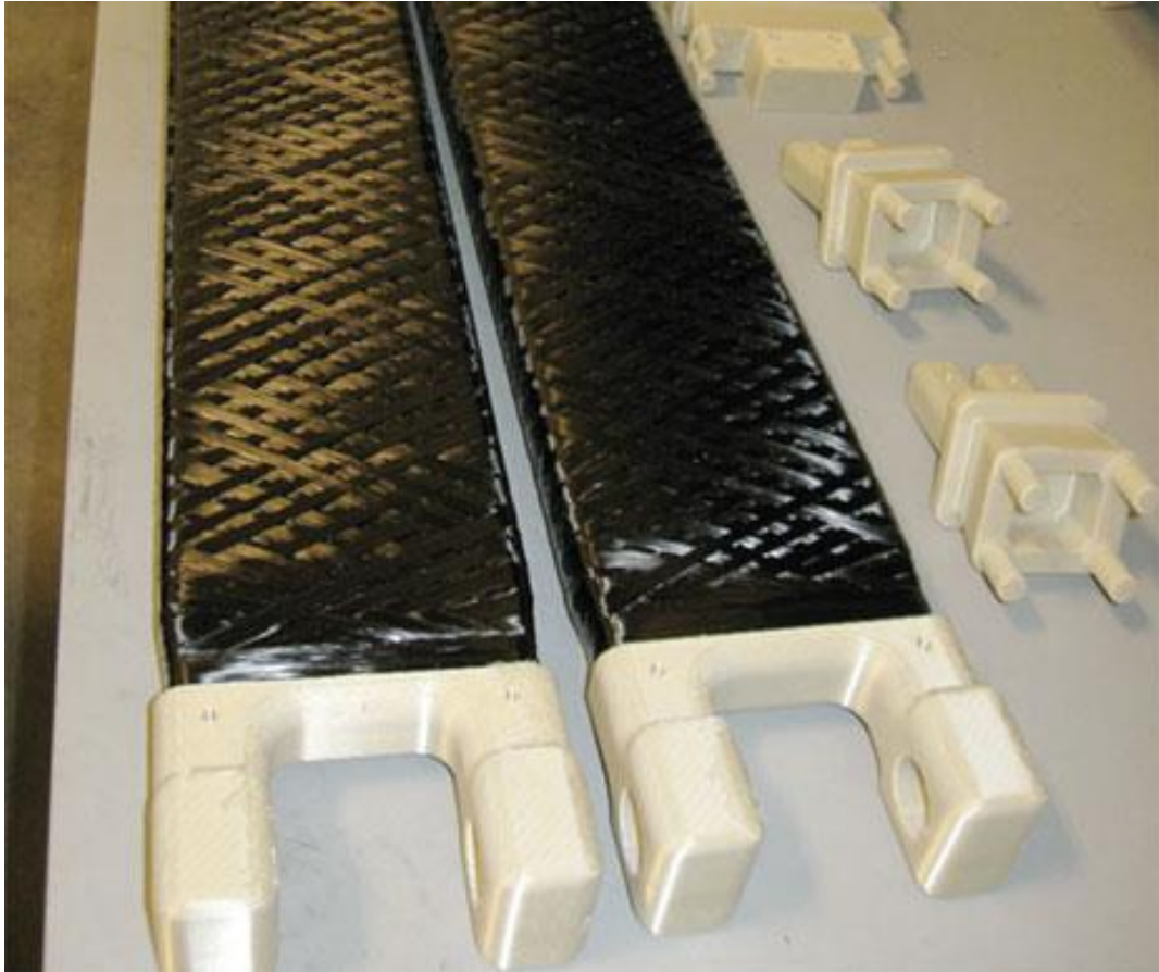
Kuva 31. Materiaalin pursotusmenetelmällä tehdyt osat, joita käytetään muotteina hiilikomposiittien valmistamiseksi. (Gibson, Rosen et al. 2015 s. 447)
