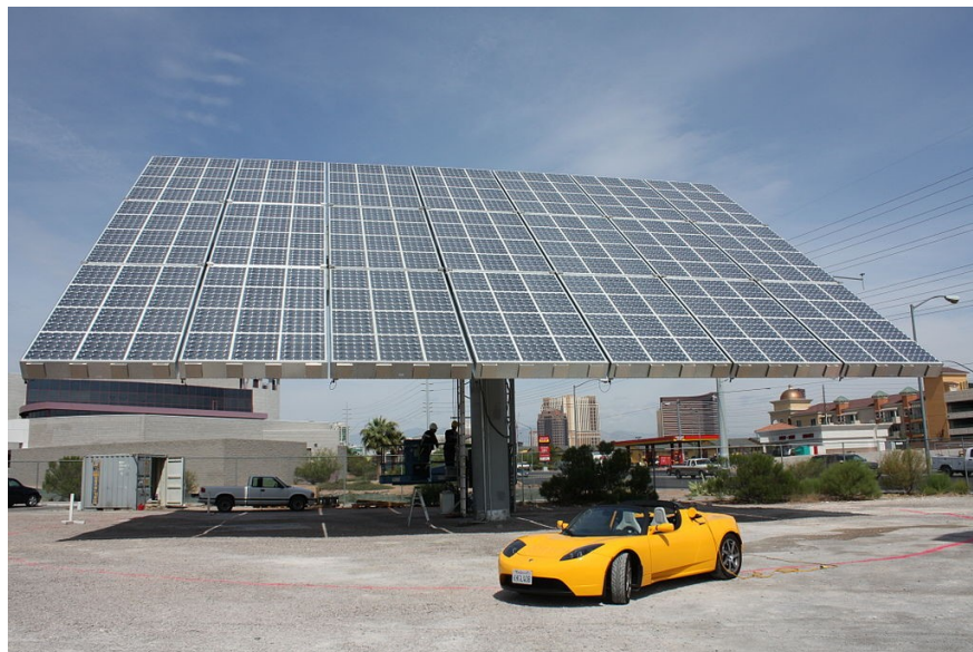
Kuva 10. Amonix-yrityksen kehittämä CPV [42].
