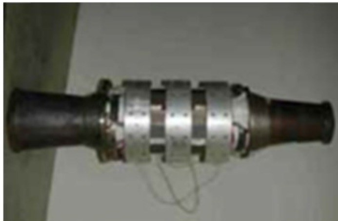
Kuva 12. Auton pakoputken päälle sijoitettu TEG [56].
