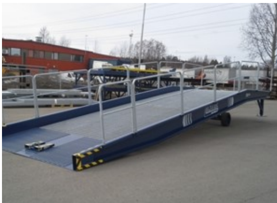
Kuva 23. Siirrettävä nousuramppi kontin purkamiseen trukilla. [32]
