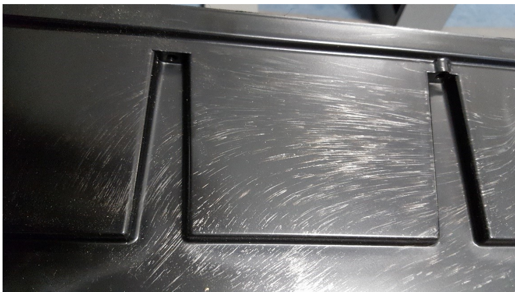
Kuva 19. Raaka-aineen kosteudesta aiheutuvia roiskejälkiä kappaleen pinnalla. [Yrityksen sisäinen materiaali]
