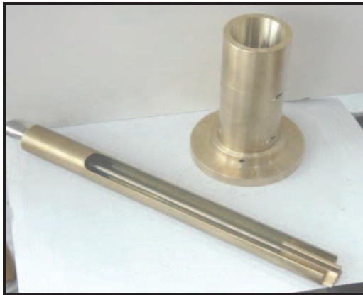
a) Molde preparado con extensión y pisón
