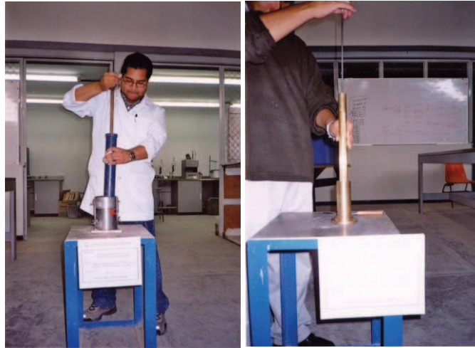
Figura 3-3 Ejecución de las pruebas de compactación: Proctor estándar (izquierda) y molde miniatura (derecha)
