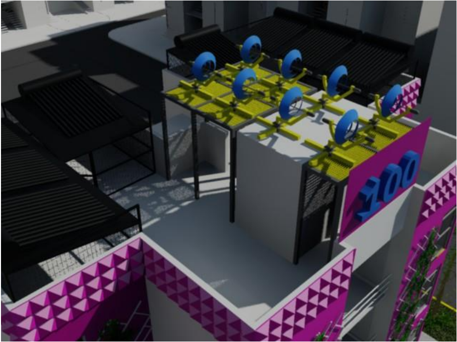
Perspectiva 6 Calentadores solares en cubierta de tendederos, a su vez hacen la función de invernadero para el secado más efectivo de la ropa.
