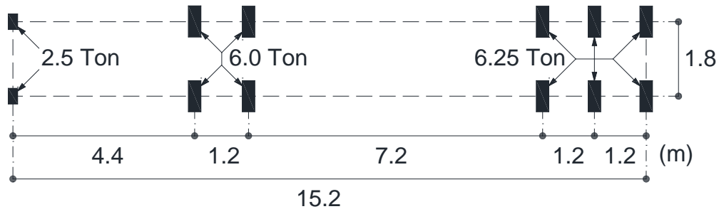
Figura No. 32 – Modelo de carga viva IMT66.5 para análisis transversal
