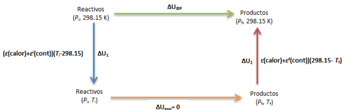
Figura 1.9 Esquema general del cálculo de \Delta U_{IBP} a 298,15 K a partir de la variación de energía interna de la bomba de proceso real \Delta U_{exp} .
