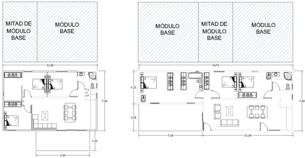
Fig. 2.10. Uso del módulo en diseño H2 y H2-2 (Esquema elaborado por el autor)
