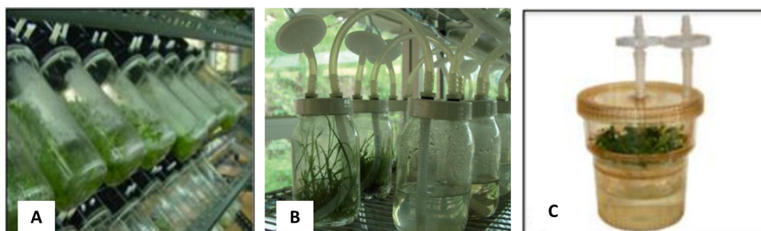
Figura 2. Los biorreactores en la micropropagación. A) Micropropagación de agave ( Agavespp. ) en BioMINT ® B) propagación de caña de azúcar ( Saccharum spp. ) en BIT ® , y C) Recipiente de Inmersión Temporal Automatizado (RITA ® ).
