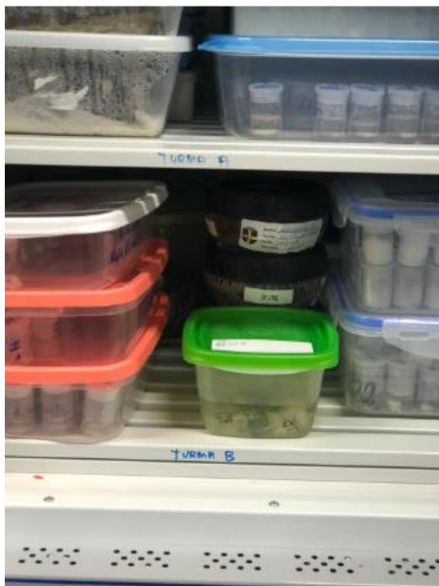
Figura 4: Estufa com as amostras no pote com tampa verde, imerso em saliva artificial
