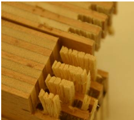
Figure 107: Test de cisaillement sur le contreplaqué non soudé (à droite) et soudé (à gauche) sur chant.
