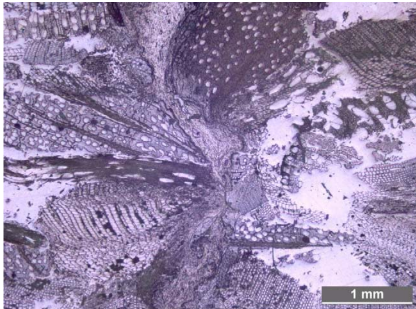
Figure 104: Observation microscopique de la ligne de soudage sur une éprouvette de PP soudée sur le chant. Les zones vides entre les particules du panneau apparaissent en clair. La ligne de soudage (traversant l'image de haut en bas) semble coller les particules entre elles.
