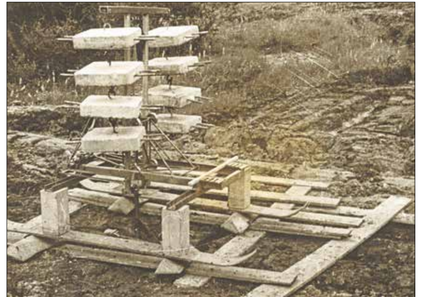
Einsinkversuche für Panzerketten an der damaligen TH Dresden. (Quelle: Nachlass Eberan von Eberhorst, R., Berichte und Untersuchungen, 1943–1944, v. Nr. 04, 2. Bericht Spezifischer Bodendruck u. Einsinktiefe, Institut für Kraftfahrwesen der Technischen Hochschule Dresden, 22. November 1943, Trittplatten-Meßgerät mit Beton-Zusatzgewichten.)
