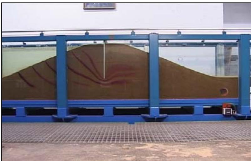
**Abbildung 28: Aufbau des physikalischen Experiments, aus (Aigner, 2004). Zu Größenangaben siehe Abschnitt 5.1.2.**
