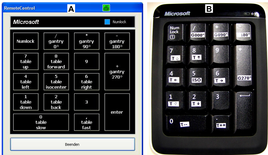
Abbildung 6: Fernsteuerung des SAIGRT: (A) GUI in der Steuerungssoftware RadControl und (B) zugehörige schnurlose Bluetooth-Ziffernblocktastatur (Microsoft Corporation).
