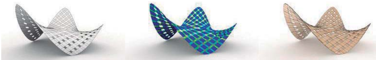
Figura 2.d: Conversión a placas sometidas a flexión activa. Figura 2.e: Análisis de Elementos Finitos. Figura 2.f: Modelo para Fabricación
