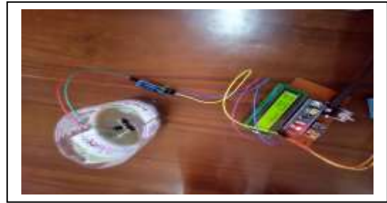
Gambar 8. Pengujian Kelembaban Tanah pada Kondisi Tanah Basah
