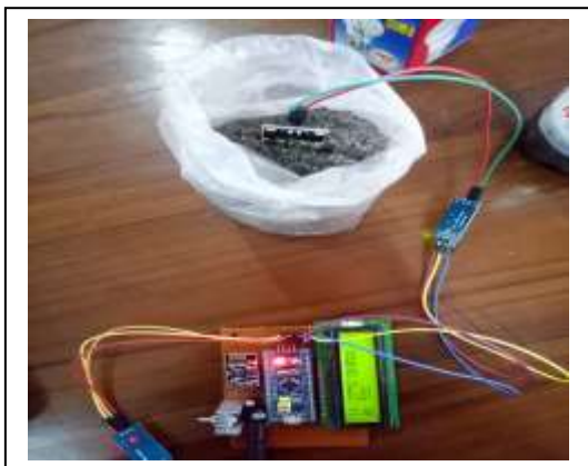
Gambar 6. Pengujian Kelembaban Tanah pada Kondisi Tanah Kering
