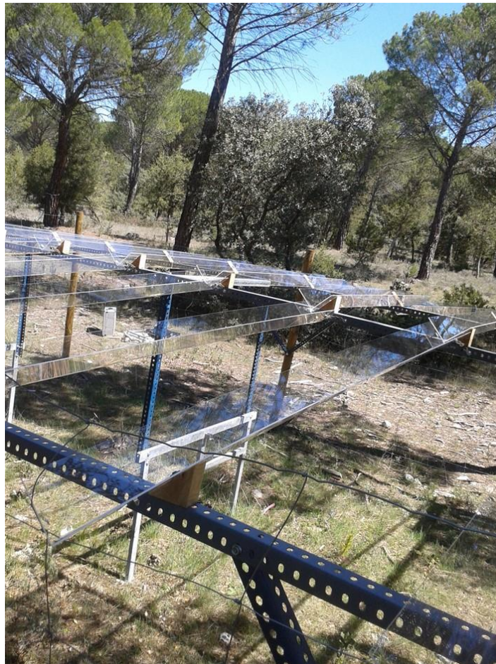
Fig. 1.9. Detalle de una parcela de plantación y su dispositivo de exclusión de precipitación.
