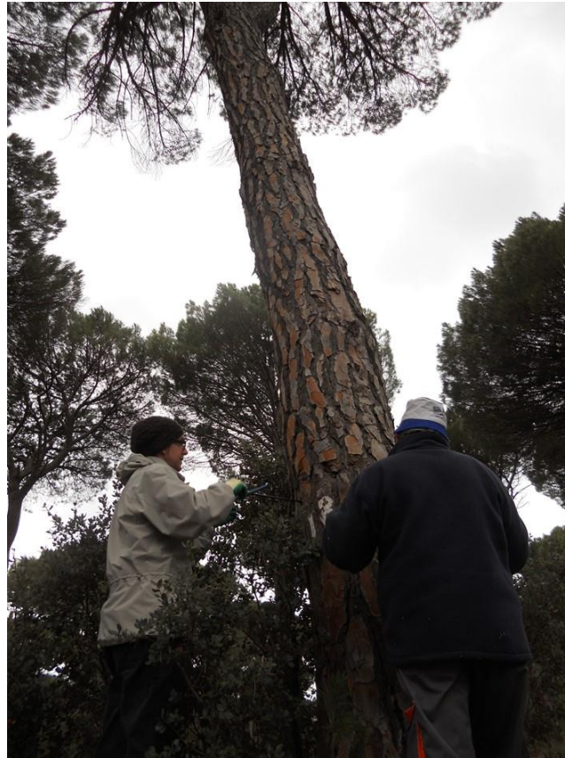
Fig. 1.5. Toma de muestras de crecimiento radial con barrena de Pressler en parcela INIA localizada en masa pura de Pinus pinea en el páramo calizo.
