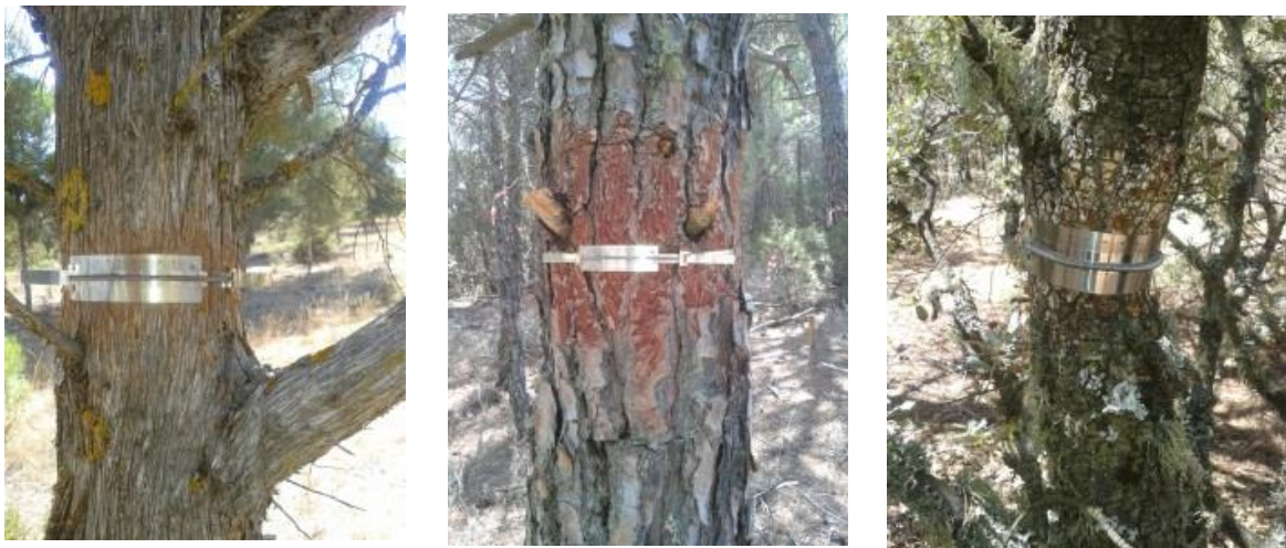
Fig. 1.7. Dendrómetros de banda instalados en las parcelas 1 y 2 del sitio de ensayo de “El Carrascal”.
