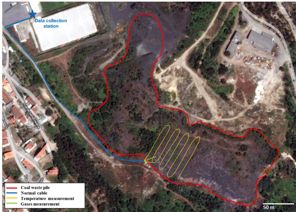
Figura 4.29: Vista general del área de combustión activa de la pila de desechos de carbón de S. Pedro da Cova y representación esquemática del sistema de fibra óptica instalado en campo [124].
