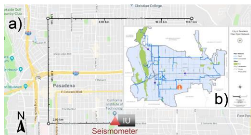
Fig. 2: (a) Distribución geométrica de la fibra utilizada como sensor en Pasadena. IU: sistema interrogador (ver Fig. 2); (b) Distribución real de la red de fibra en la ciudad de Pasadena.
