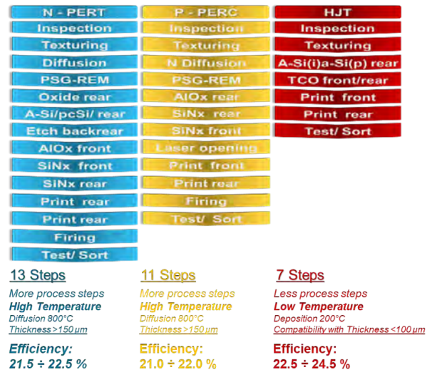
Figura 14: Confronto fra i flussi di processo per realizzare celle PER e PERT e celle HJT. Il processo HJT ha un minor numero di operazioni rispetto a PERC e PERT. Questo rende molto più efficace l'utilizzo di operazioni automatizzate, riducendo i costi necessari per realizzare le celle. Inoltre a tecnologia HJT è un processo a bassa temperatura e ciò permette di preservare al meglio le proprietà intrinseche delle fette di silicio e permette l'utilizzo di fette più sottili. Il processo PERC e PERC+ si basa sulla diffusione di droganti e richiede quindi alte temperature (>800°C) che degradano le caratteristiche elettriche e meccaniche del wafer. Per la HJT i processi di deposizione avvengono a temperatura relativamente bassa e la massima temperatura è inferiore a 200°C, consentendo di preservare le proprietà elettriche e meccaniche dei wafer e permettendo l'utilizzo di wafer più sottili (riducendo il costo del silicio).
