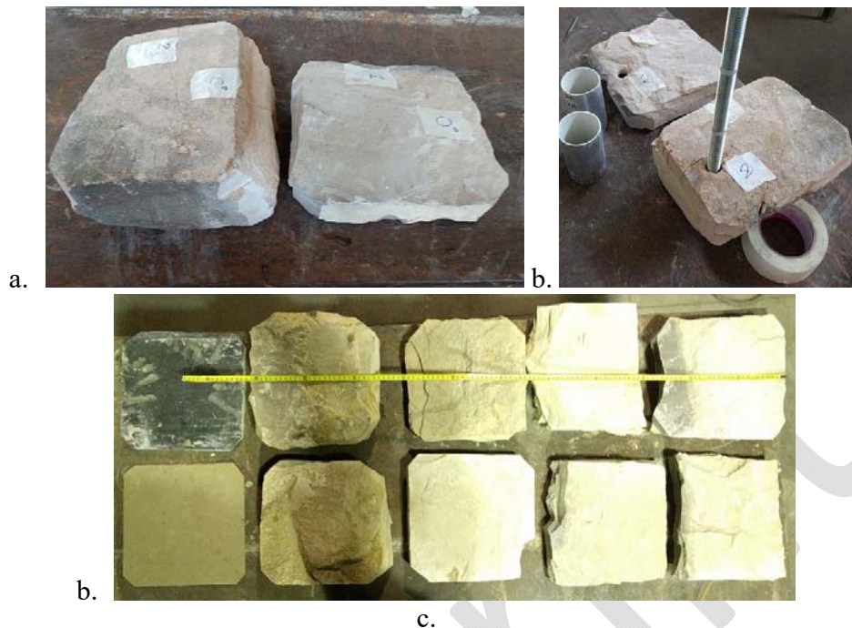
Figura 3. a. Dos tipos diferentes de estratos con variación apreciable de espesor. b. Estratos con perforación para guía de ondas colocada. c. Diferentes estratos utilizados para ensamblar las probetas (arenisca, caliza y pizarra) y su tallado para montaje dentro de cada probeta
