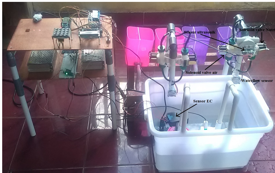
Gambar 7. Hasil perancangan sistem pengatur EC
