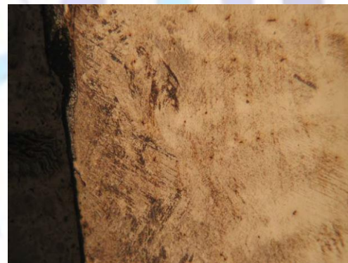
Figure 24. Coupe Micrographique d'acier1 après traitement mécanique, grossissement 200X.
