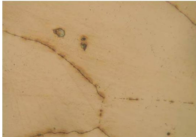
Figure 2. Coupe micrographique d'acier 1, grossissement 500X
