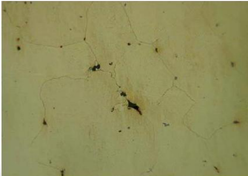
Figure 10. Coupe micrographique d'acier 2, grossissement 200 X.
