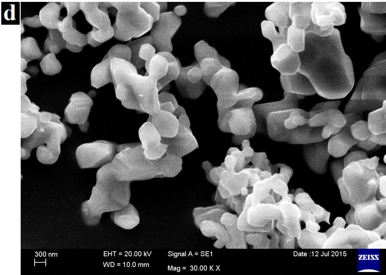
Fig.4 SEM images of Mn_3O_4 nanoparticles (a) 1h (b&c) 12h (d) 24h
