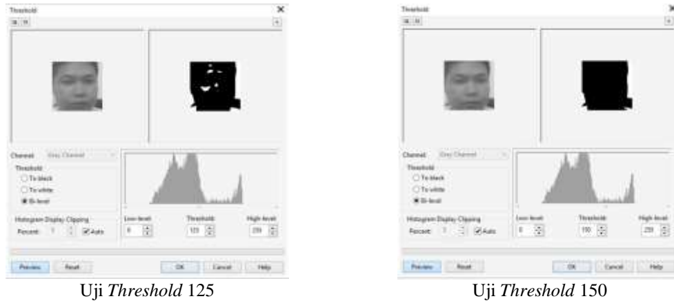
Gambar 3.14 Hasil Uji Threshold menggunakan Matlab R21012a
