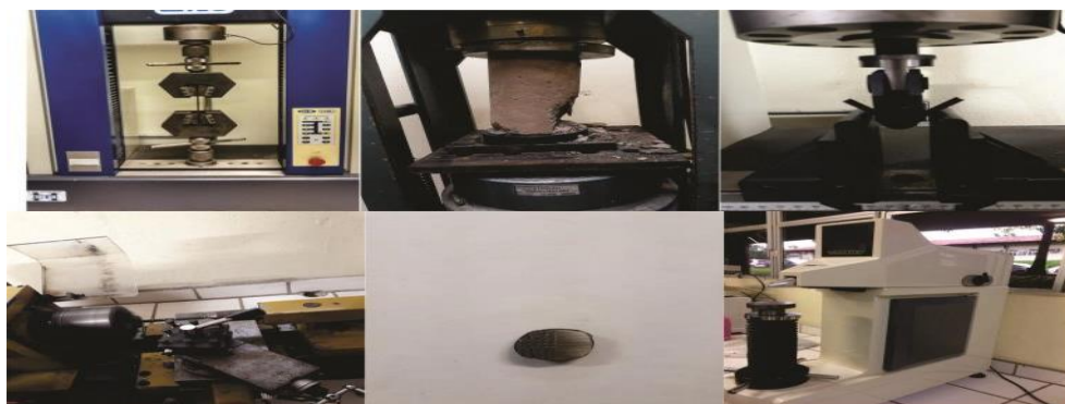
Figura 1 – Ensaio de (a) tração, (b) compressão, (c) flexão e (f) dureza; (d) Preparação de amostra; (e) peça após ensaio de dureza.
