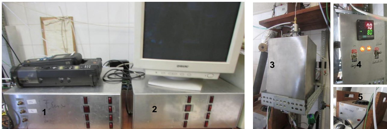
Figura 3.4 – Pormenor da unidade de controlo de gás (UCG) (1), do sistema automático de controlo e monitorização dos caudais utilizados (2), do forno (3), do controlador de temperatura (4), da carga que alimenta o controlador de temperatura (5) e do analisador (6).
