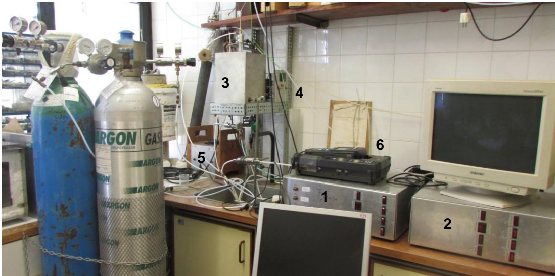
Figura 3.3 – Montagem laboratorial. Unidade de controlo de gás (UCG) (1), Sistema automático de controlo e monitorização dos caudais utilizados (2), Forno (3), Controlador de temperatura (4), Carga que alimenta o controlador de temperatura (5) e Analisador (6).
