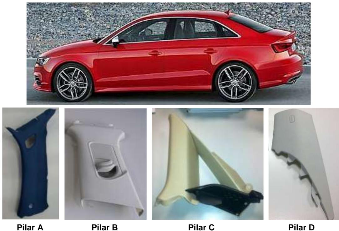
Figura 18. Audi A3 Limousine e Pilares internos em tecido.
