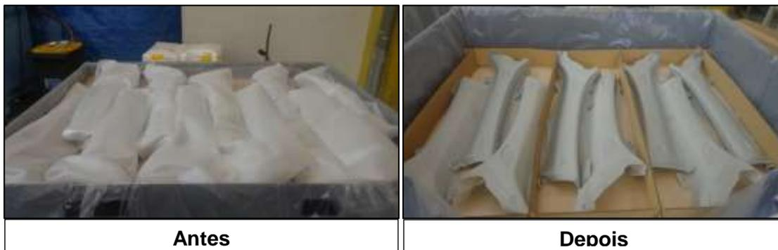
**Figura 47. Nova configuração da Gama de Embalagem do Pilar A**
