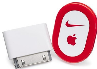
Figura 7- Nike Plus – Sensor de movimento para produtos Apple
