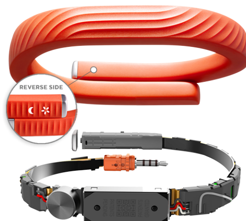
Figura 5 - Jawbone UP – Interior da pulseira
