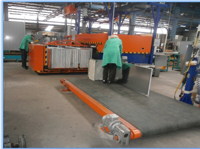
Figura 19 - Processo de calafetagem e injeção da célula Monobloco
