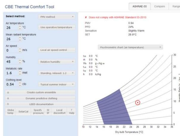
Figura 67 - CBE Thermal comfort tool para a região de maior desconforto (gráfico temperatura do ar)
