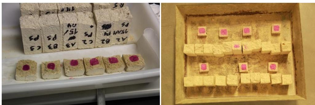
Figura 23 – Ensaio de indicador de fenolftaleína para determinar a carbonatação dos provetes
