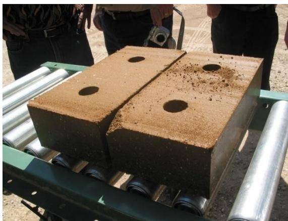
Figura 7 - Blocos de terra comprimida, BTC [13]
