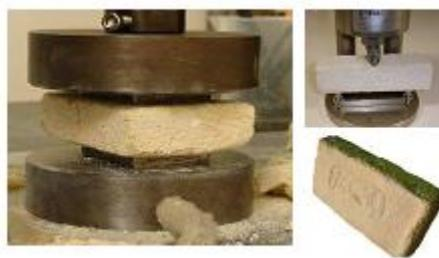
Figura 2 - Compressão simples e ensaio de flexão de um bloco individual de adobe [5]
