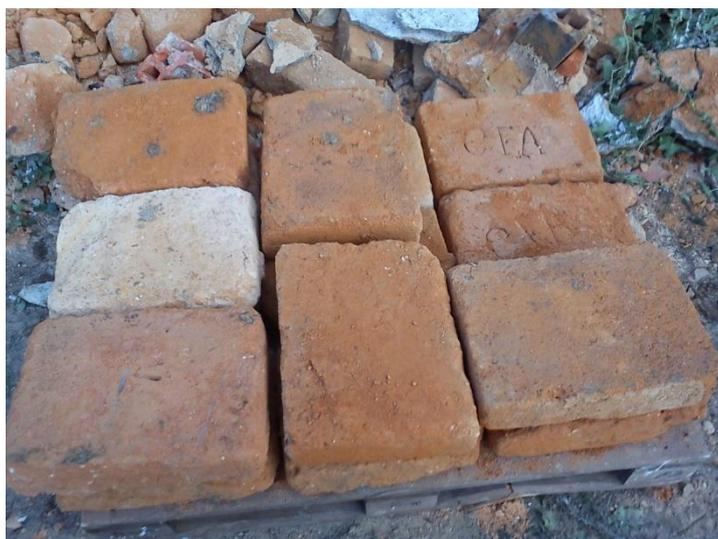
Figura 14 – Fotografia dos adobes recolhidos durante o desmonte do muro
