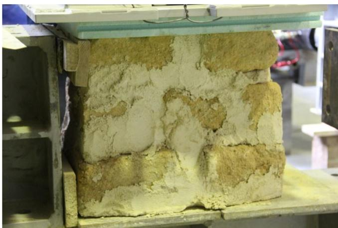
Figura 34 – Exemplar de murete utilizado no ensaio de corte RILEM LUMB5
