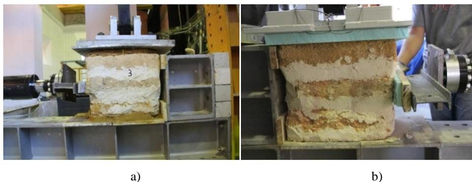
Figura 29 – Realização do ensaio com diferentes materiais na aplicação das cargas axial e de corte: a) carga axial com camada de areia molhada e carga de corte com uma tábua de madeira, b) cargas axial e de corte aplicadas com recurso a poliestireno extrudido
