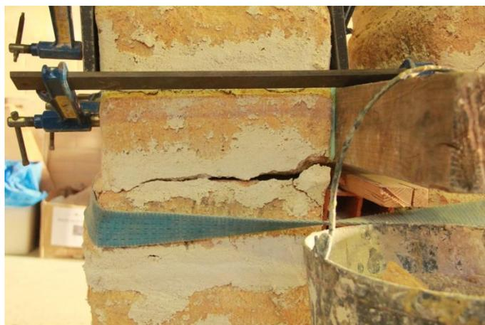
Figura 40 – Arrancamento dos adobes 8 e 9 na parede 1
