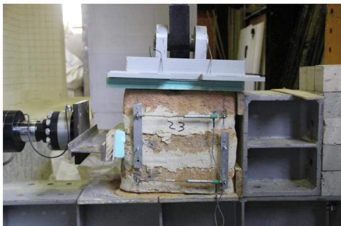
Figura 30 – Exemplo da disposição dos transdutores
