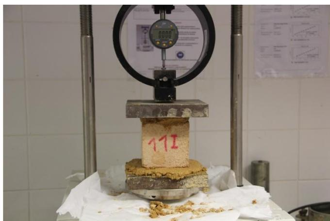
Figura 26 – Setup do ensaio de compressão
