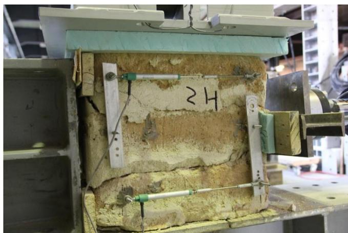
Figura 31 – Rotura das juntas de assentamento
