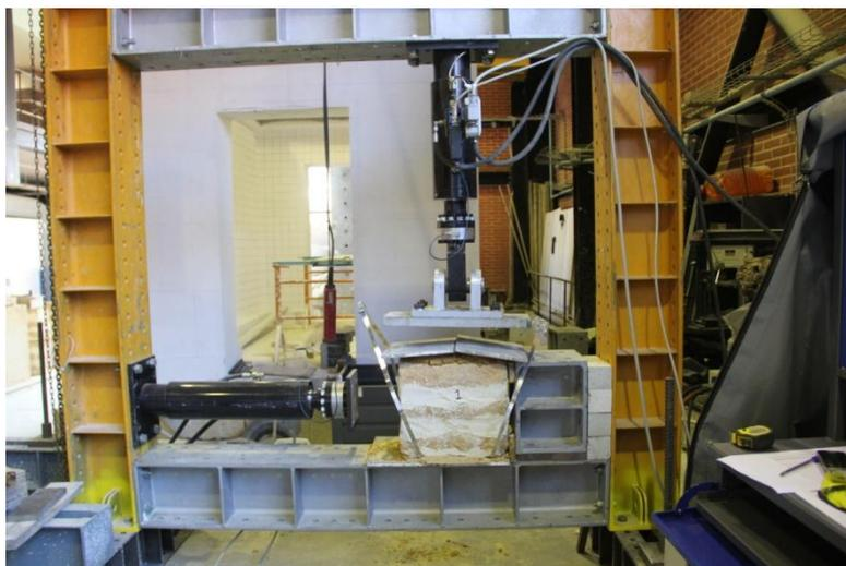
Figura 28 – Configuração do pórtico e dos servo-atuadores para o ensaio
