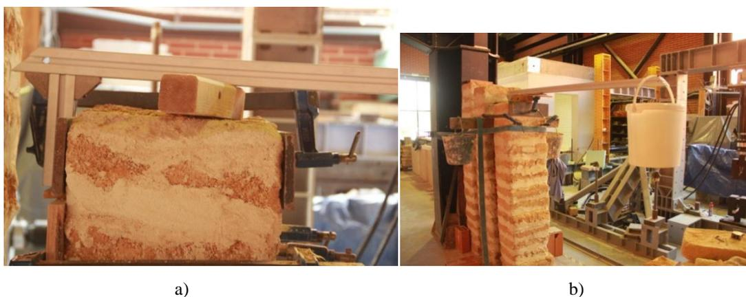
Figura 38 – Sistema de alavanca de arrancamento: a) Pormenor do sistema, b) Vista geral
