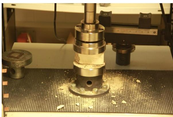
Figura 22 – Ensaio de compressão de um dos provetes de argamassa
