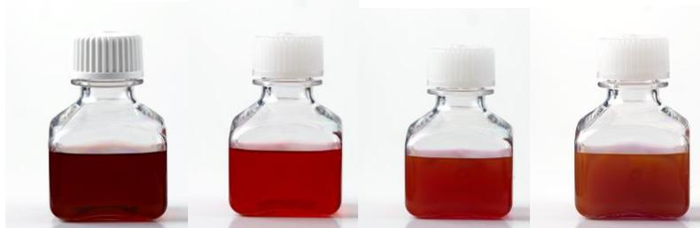
**Figura 9** - Influência do tamanho médio das nanopartículas de Au na cor resultante do coloide (da esquerda para a direita: 5 nm, 15 nm, 70 nm e 100 nm). (45)
