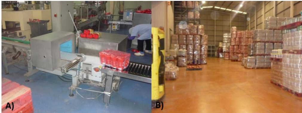
Figura 7 - A) Máquina de detetor de metais, por onde as embalagens passam no final do embalamento; B) Armazenamento do arroz embalado.
