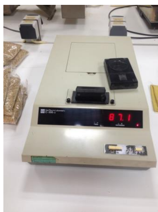
Figura 10 – Aparelho para a determinação do Kett .
