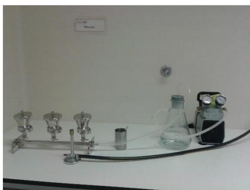
Figura 12- Rampa de filtração usada na análise dos vários parâmetros em águas no laboratório Yourlab S.A.
