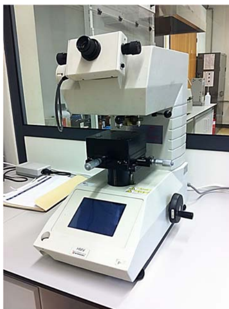
Figura V.10 - Equipamento utilizado para medição da dureza nas superfícies transversais à superfície maquinada dos provetes.
