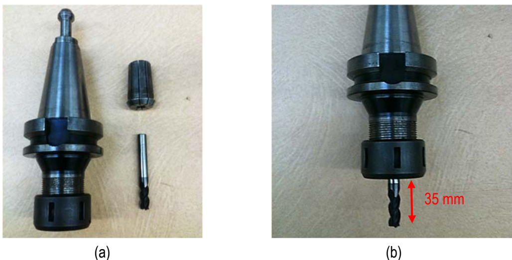
Figura V.6 - Suporte mecânico e pinça de aperto da ferramenta (a) e esquema do aperto da ferramenta utilizada nos testes (b)
