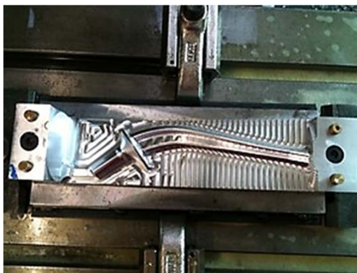
Figura V.33 - Resultado obtido da prótese femoral depois de efetuar a operação de desbaste relativa ao 2º Aperto.
