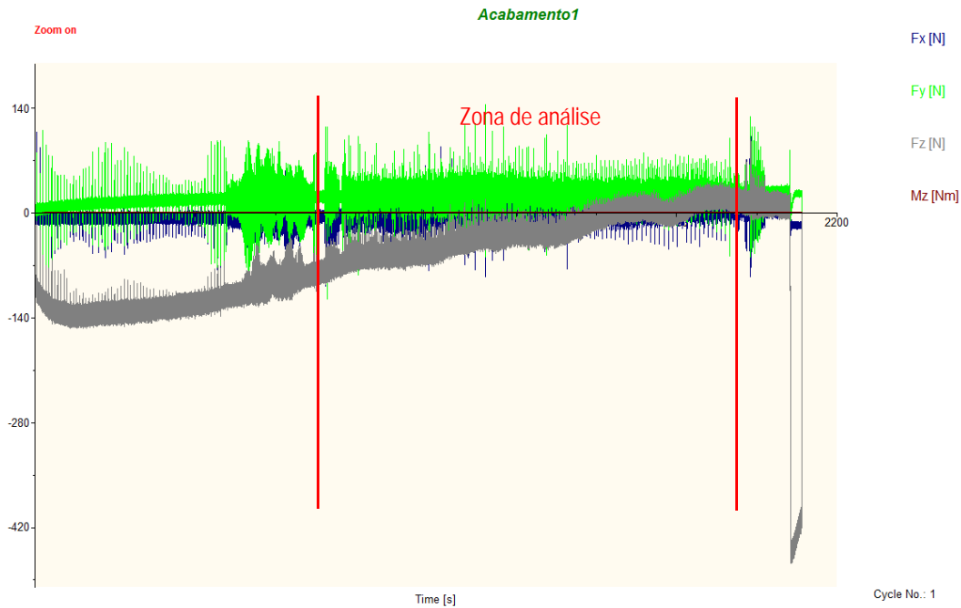
Figura VI.57 - Evolução das forças de maquinagem durante a operação de acabamento da prótese femoral na liga de titânio, com uma fresa de ponta esférica.
