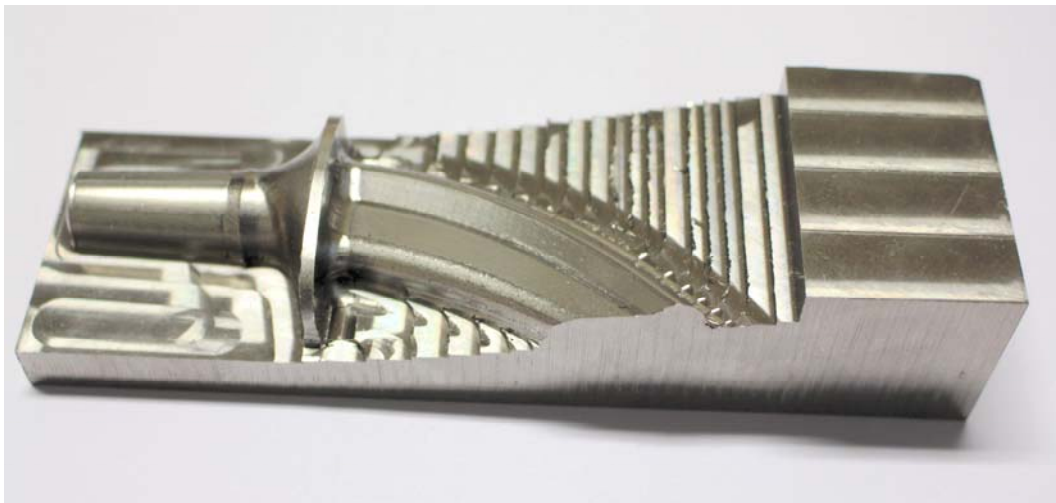
Figura VI.62 - Prótese femoral na liga de Ti-6Al-4V, depois de efetuadas as operações de maquinagem.
