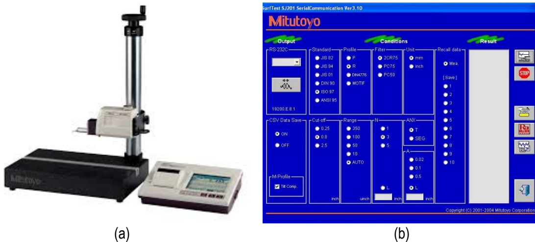
Figura V.11 - Perfilmetro Mitutoyo SurfTest 401 usado para medição da rugosidade (a) e respetiva interface gráfica para guardar o perfil de rugosidade no PC.
