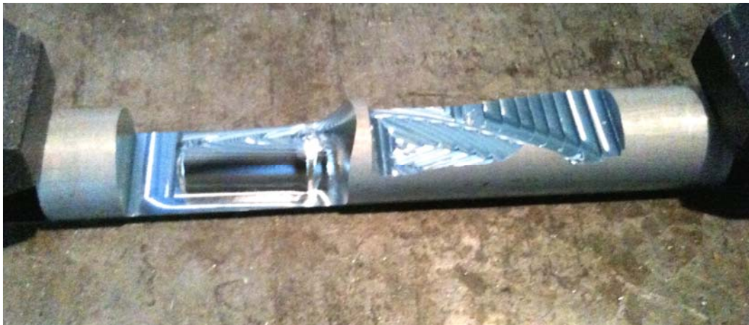
Figura VI.72 - Resultado da operação de desbaste efetuado na liga Co-28Cr-6Mo.
