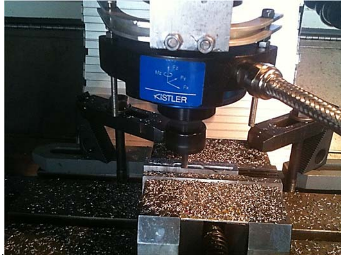
Figura VI.3 - Exemplo da aquisição das forças de corte na liga Ti-6Al-4V.
