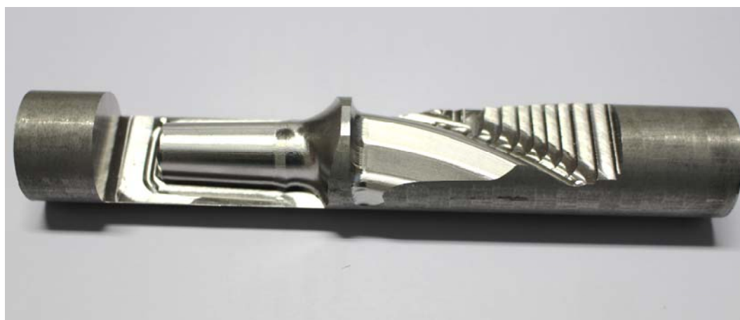
Figura VI.79 - Prótese femoral na liga Co-28Cr-6Mo, depois de efetuadas todas as operações de maquinagem.
