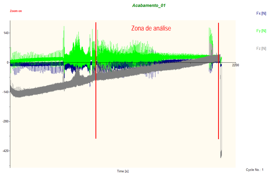
Figura VI.74 - Evolução das componentes da força de corte durante a operação de acabamento na liga de cromo-cobalto, com uma fresa de ponta esférica.
