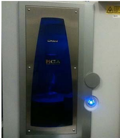
Figura V.8 - Scanner laser 3D usado para adquirir a geometria 3D da prótese maquinada.
