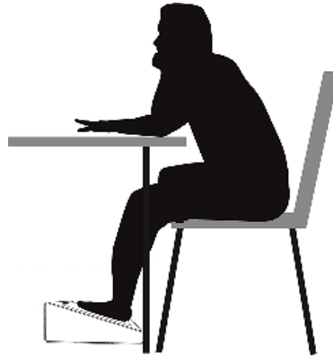
Figura 37 - Modo de operacionalidade do conceito final: Scanner adaptado. O paciente, confortavelmente sentado, posiciona os pés no topo do equipamento, contendo uma folha de cristais líquidos, para que se realize uma digitalização da imagem obtida por essa mesma folha.
